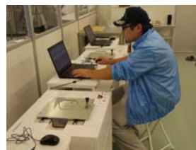
CsIやNaIシンチレーション 検出器で検査 (小名浜魚市場検査室)
